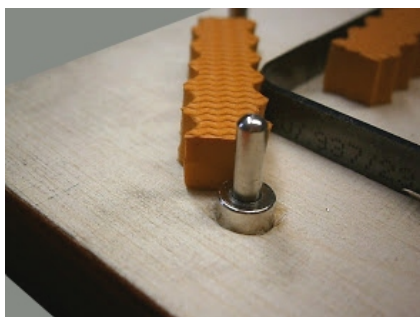
Ergots rétractables pour le positionnement précis des matières à couper
