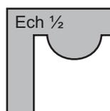
Outil "coup de pouce" pour réaliser des onglets ou des encoches pour crochets calendriers
