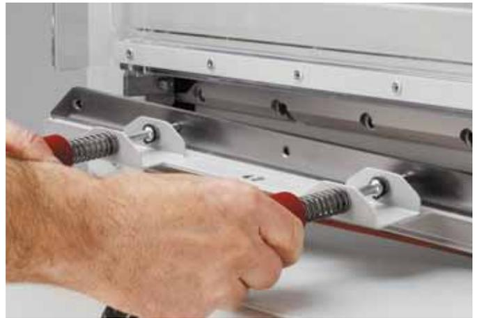
**REPLACEMENT SÉCURISÉ DE LA LAME** Remplacement aisé de la lame sans démonter les carters, à l'aide d'un dispositif protégeant le tranchant.
