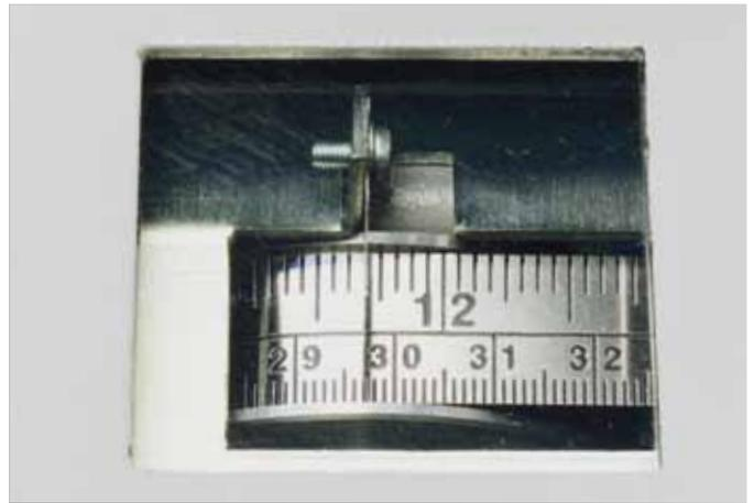
**RÉGLAGE DES DIMENSIONS** Le ruban gradué pour le positionnement de la butée arrière, facilement lisible, est incorporé dans la table avant du massicot.
