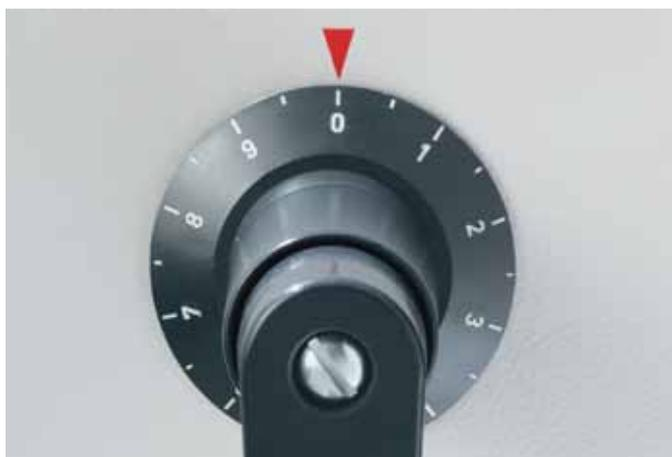
**MANIVELLE** L'utilisation combinée de la bague graduée sur la manivelle et de la butée latérale graduée permet une mise en place précise du papier.
