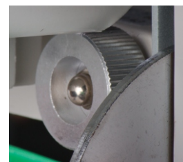
Réglage du parallélisme des plis
