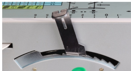
Réglage de pression des roulettes prise papier
