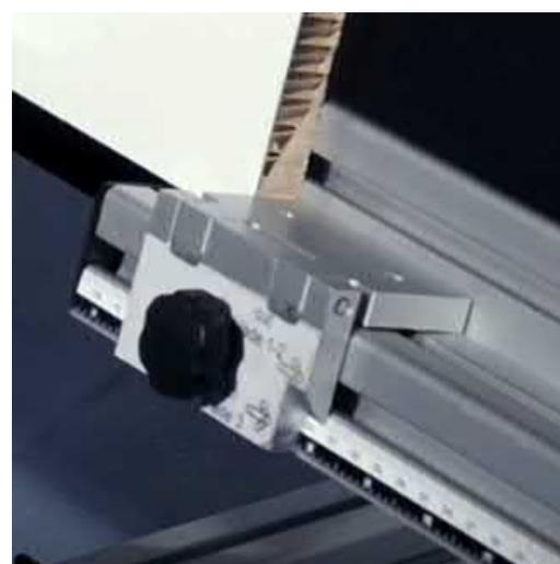
Règle graduée et taquet mobile pour le positionnement des panneaux
