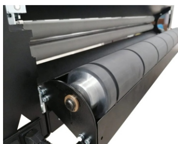
Accès très facile aux rouleaux de pliage pour l'entretien et pour enlever d'éventuels brouillages
