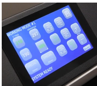
Panneau de commande avec Ecran LCD muni de touches sensibles et menus déroulants
